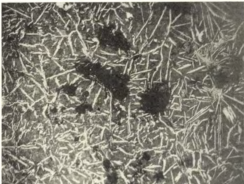
1. Soproni buca szövete: perlites alapon cementit tűkristályok. A felvétel az öntött kovácsolt szövet átmenetét mutatja. A kovácsolás nagyrészt összenyomta az üregeket, a cementit tűkristályok részben szétterjedtek illetve összegyűrődtek. N = 20 \times . Maratás: 3%-os alkoholos salétromsav
